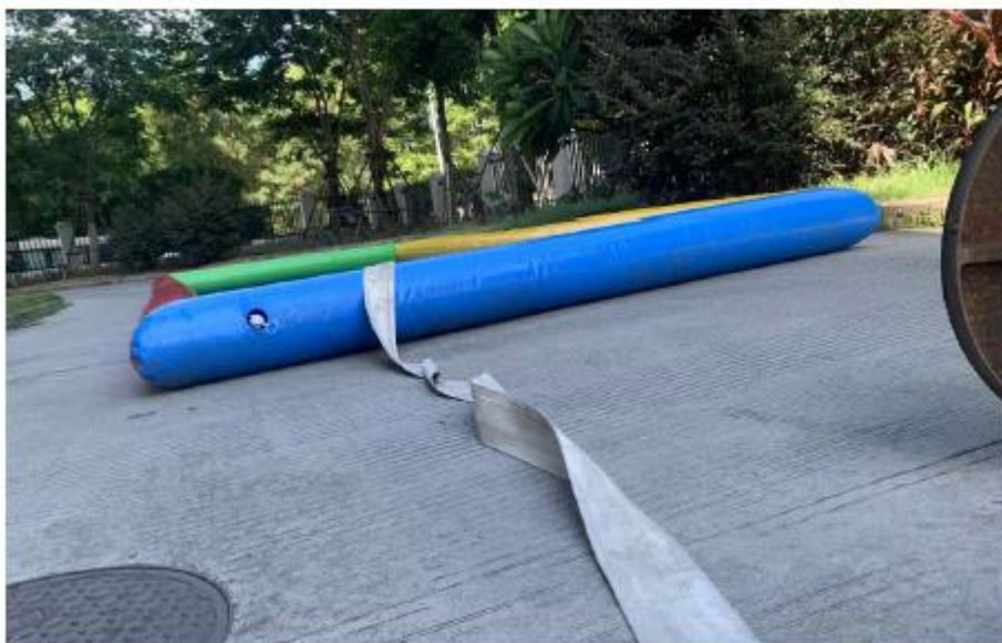
抽水至应急水池
